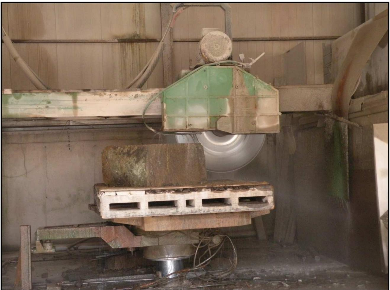
Figura 9: Esempio di sega a bandiera usata nel settore estrattivo della PAT
